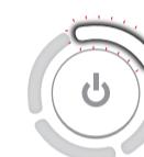
Lorsque le niveau de la batterie est faible, un seul témoin lumineux clignote : ceci indique que la batterie doit être rechargée.
