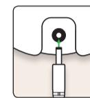
Pour charger l'appareil, branchez l'adaptateur électrique sur la station de charge, et branchez sur le secteur.
